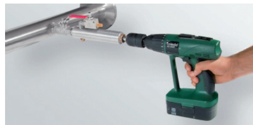
Anbohren unter Druck mit der BMG Bohrvorrichtung
