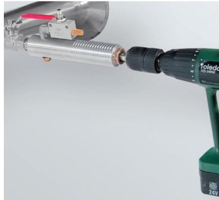
Falls die Anlage nicht heruntergefahren werden kann, d.h. drucklos gestellt werden kann, kann mit Verwendung der Bohrvorrichtung (Best.-Nr. 0530 1108) unter Druck gebohrt werden.
