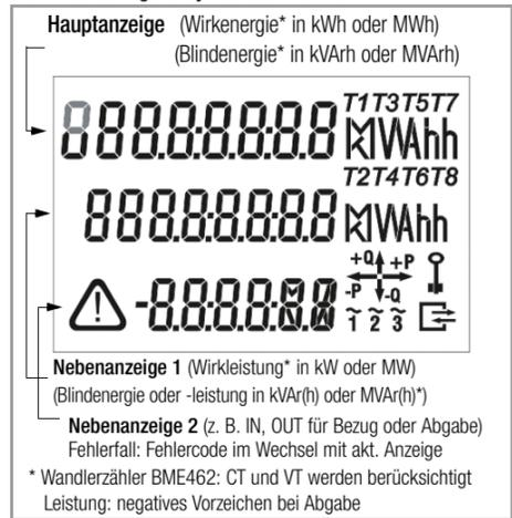
**Hauptanzeige** (Wirkenergie\* in kWh oder MWh)
